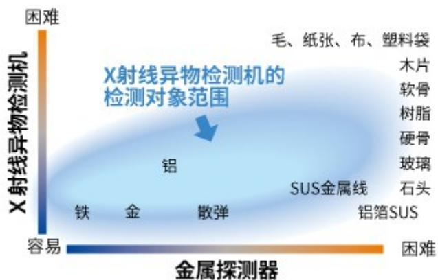
X射线异物检测机与金属探测器一异物检测的强项领域不同X射线异物检测机除了可检测出金属, 还可检测出石头、塑料、残骨等非金属异物。另外, 金属探测器的强项在于检测铁或铝等金属异物。由于检测原理不同, 因此需要按照检测目标异物的种类, 来选择相应的机型。
